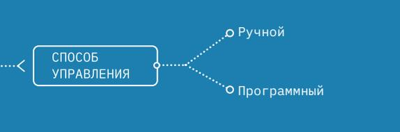
Самый оптимальный тип управления роботом – программный: он подразумевает постоянное выполнение заранее заданного сценария. Как правило, именно такой метод используется для управления роботами на промышленных объектах. Ручной способ управления осуществляется с помощью пульта, на котором оператор управляет передвижением робота, а также осуществляет выполнение и корректировку программ.
