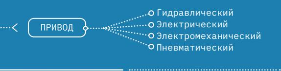
Приводы в роботах позволяют преобразовать подводимую энергию в работу. В роботе может использоваться один из перечисленных приводов либо их комбинация. В последнее время подавляющее большинство промышленных манипуляторов используют электрические приводы.
