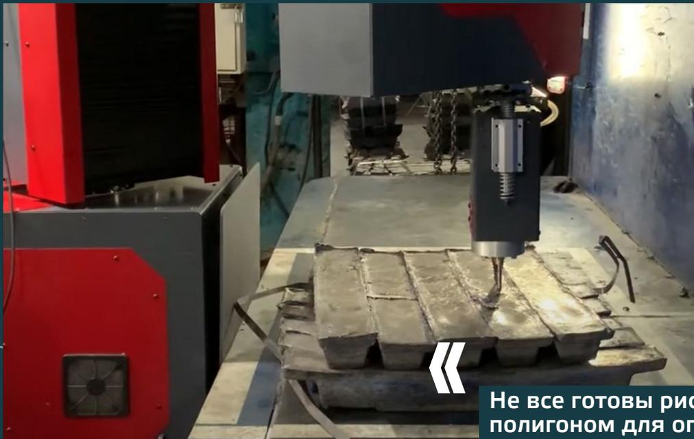
Робот-манипулятор Agirix для укладки свинцовых и алюминиевых слитков в печь, завод «Москабель»
