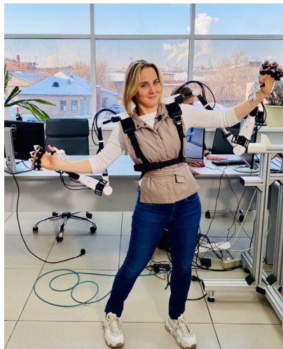
Экзоскелет для верхней части тела помогает снять нагрузку с позвоночника при тяжелой работе
