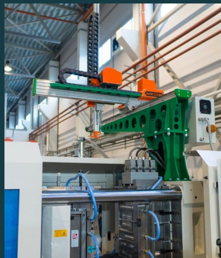
Российский декартный (картезианский) промышленный робот-манипулятор ARKODIM
