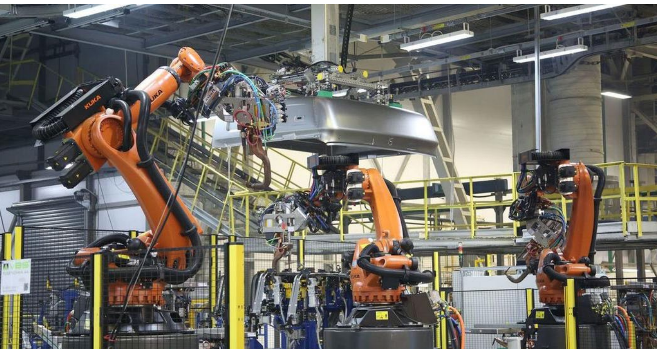
Сварка крыши кабин
