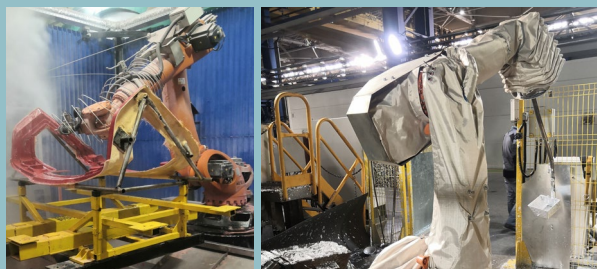
Роботизированный комплекс гидроабразивной резки композитных материалов на базе робота KUKA для АО «Петербургский тракторный завод»
