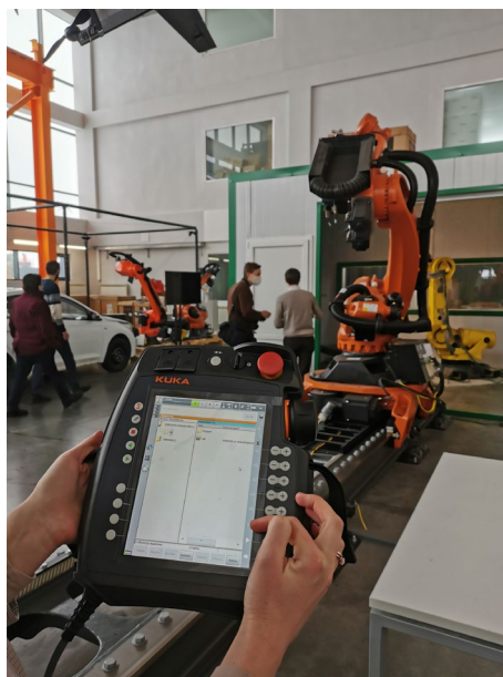
Промышленный робот-манипулятор на линейной оси от компании KUKA и сотрудник лаборатории робототехники. Робот-манипулятор на линейной оси расширяет свою рабочую зону за счет перемещения по линейной оси
