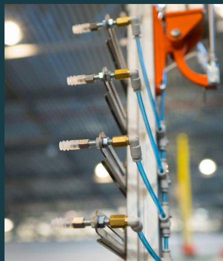
Вакуумный захват для извлечения основ зубных щёток из пресс-формы
