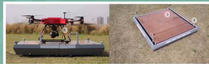
Платформа Ewart Aerospace. 1 - опора БЛА с электродами; 2 - посадочная площадка; 3 - толкатели с электродами
